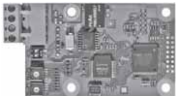
Fig. 77 Grundfos CIM communication interface module
