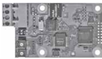
Fig. 77 Grundfos CIM communication interface module
