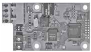
Fig. 77 Grundfos CIM communication interface module
