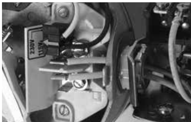
Figure 9 : Tension réglée à 115 volts sur sélecteur à fiche
