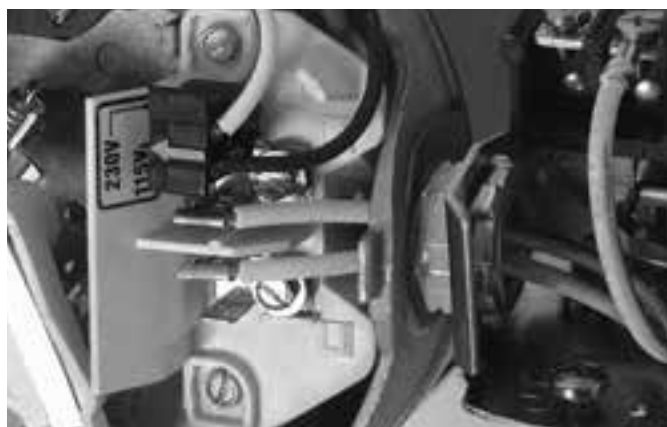
Figure 7 : Tension réglée sur le courant de 115 volts. Sélecteur à fiche
