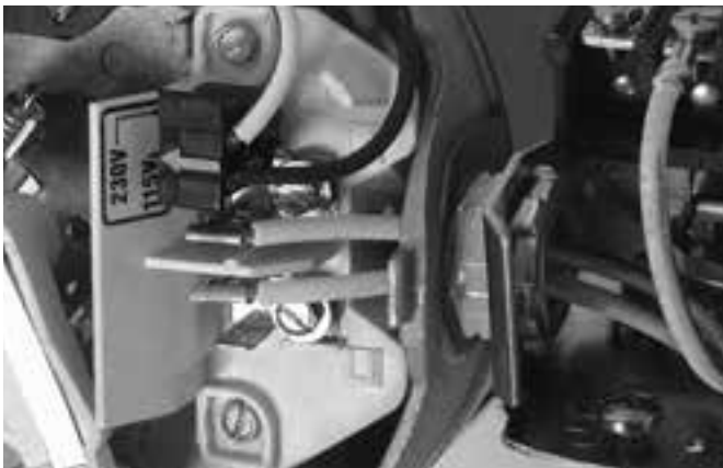
Figura 7: Tensión configurada para 115 voltios, tipo ficha
