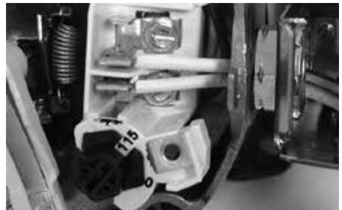
Figura 9: Tensión configurada para 115 voltios, tipo cuadrante
