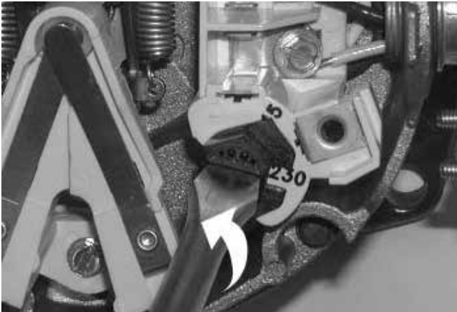
Figura 12: Cambio de la configuración de tensión
