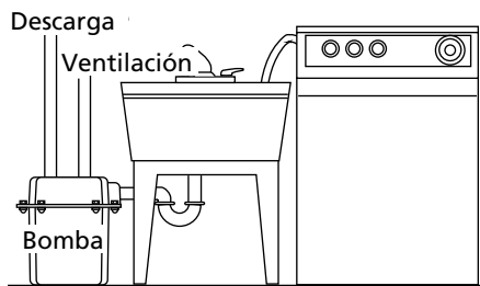
Figura 10 - Instalación típica en lavaderos y lavarropas
