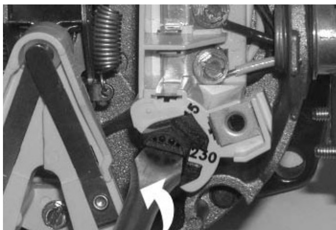
Figura 3: Cómo cambiar la configuración de tensión
