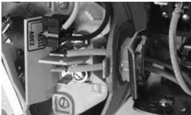
Figura 6: Tensión configurada para 115 V, tipo ficha.
