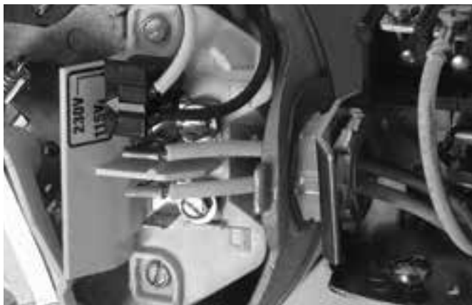
Figura 6: Tensión configurada para 115 V, tipo ficha.
