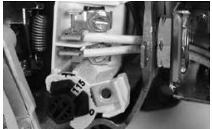
Figura 8: Tensión configurada para 115 V, tipo cuadrante.
