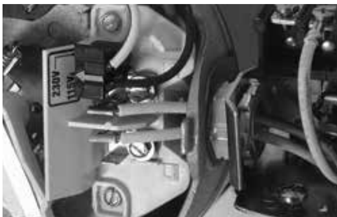
Figura 9: Tensión configurada para 115 V, tipo ficha.
