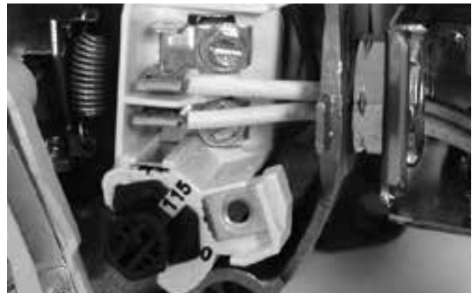
Figure 11 : Tension réglée à 115 V sur sélecteur à cadran
