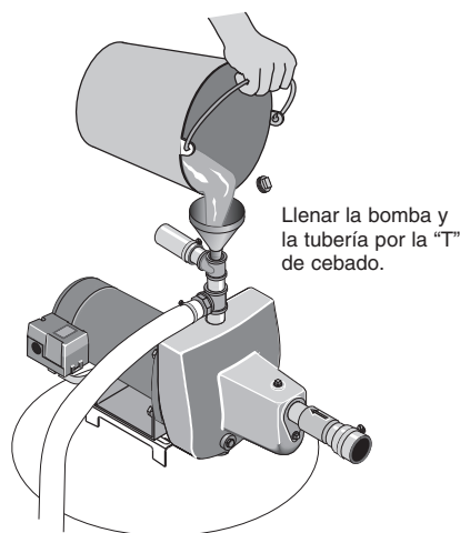
Figura 9: Llenado de la Bomba
